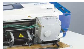
Serbatoio dell'olio sigillato in alluminio
